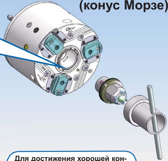
Для достижения хорошей концентричности прижимайте заготовку к торцевому поводку с помощью задней бабки. После этого вручную перезатяните стопорную гайку с помощью монтажного ключа.
