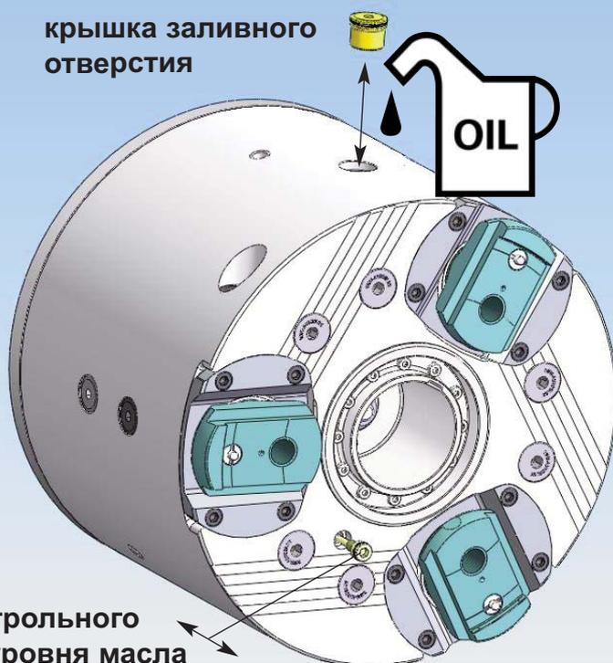
крышка заливного отверстия
