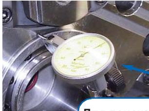
Для поиска правильного положения патрона на шпинделе (регулировке) установите циферблатный индикатор на внешнее кольцо корпуса патрона.
