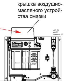
крышка воздушно-масляного устройства смазки
