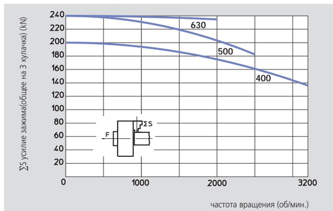
Данные на диаграммах относятся к новому 3-х кулачковому патрону, установленному по сервисной инструкции с применением SMW-AUTOBLOK смазки K05. Статическое и динамическое усилие зажима измерялось на стандартных мягких накладных кулачках, не выступающих за диаметр патрона.
