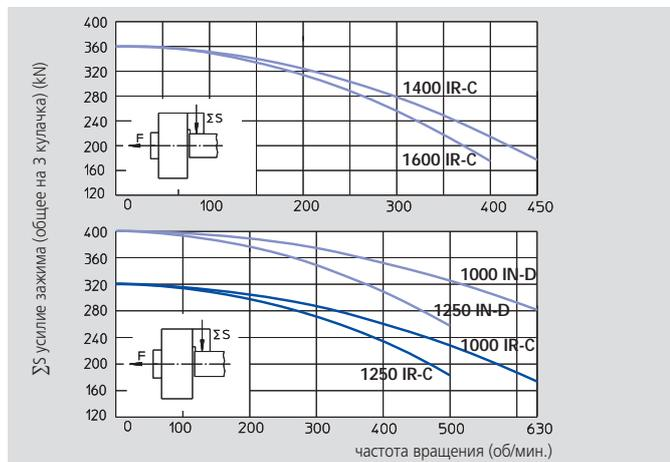
Данные на диаграмме относятся к новому 3-х кулачковому патрону, установленному по сервисной инструкции с использованием SMW-AUTOBLOK смазки K05. Статическое и динамическое усилие зажима измерялось на стандартных мягких накладных кулачках, не выступающих за диаметр патрона.
