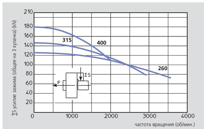
Данные на диаграмме относятся к новому 3-х кулачковому патрону, установленному по сервисной инструкции с использованием SMW-AUTOBLOK смазки K05. Статическое и динамическое усилие зажима измерялось на стандартных мягких накладных кулачках, не выступающих за диаметр патрона.
